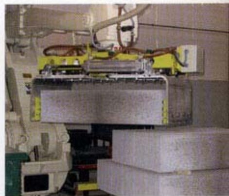
Einer von drei integrierten Verpackungsrobotern der neu entwickelten Gesamtanlage
